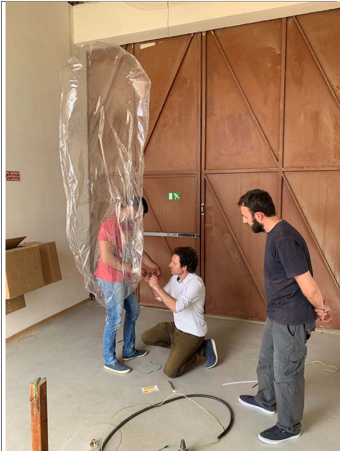
Το γέμισμα με υδρογόνο του μπαλονιού σταθερού όγκου για το ανέβασμα του μικροδορυφόρου «Ερμής»
